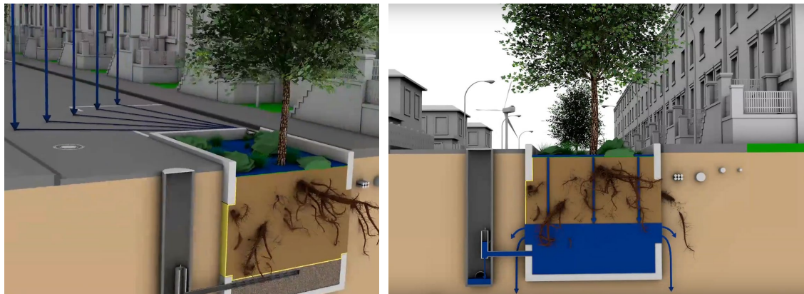
Abbildung 4.5: Versickerungsanlage Baum-Rigole mit gedrosselter Ableitung 5
