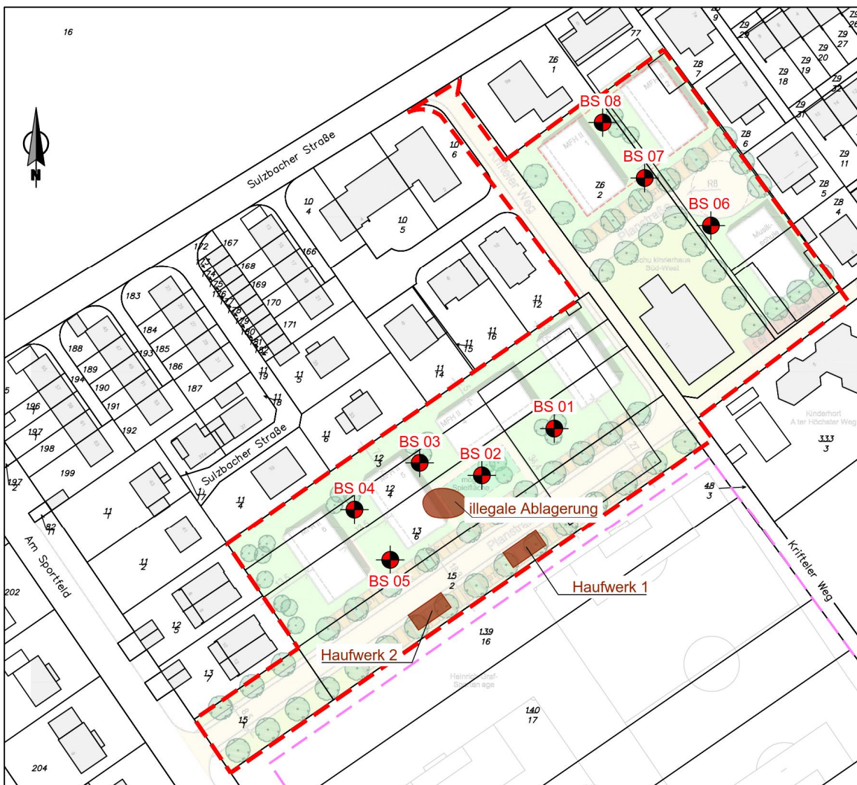
Abbildung 3: Lageskizze mit Kennzeichnung der Baugrundaufschlüsse und Ablagerungen
