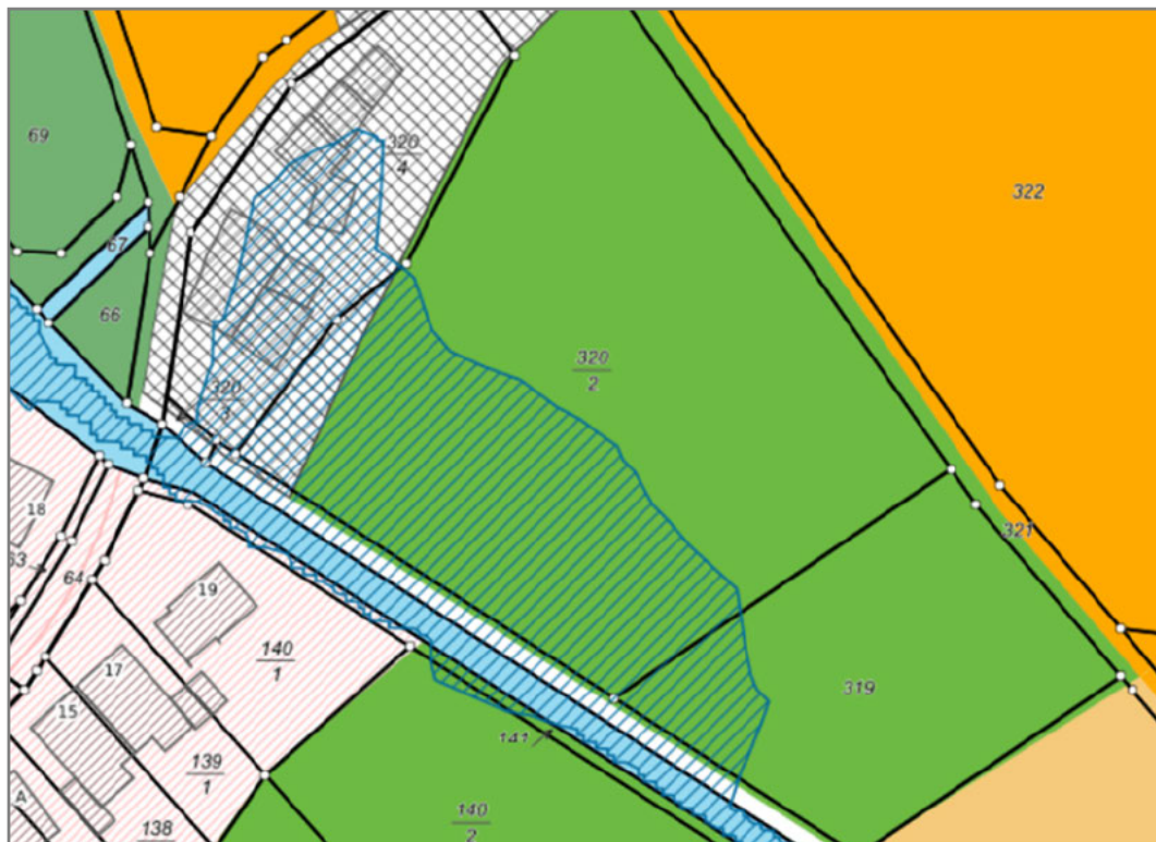
Abbildung 13: Überschwemmungsgebiet im Baugebiet [13]
