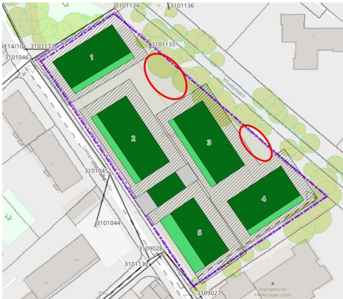
**Abbildung 22:** potenzielle Flächen für die Versickerungsanlagen (rot umkreist)
