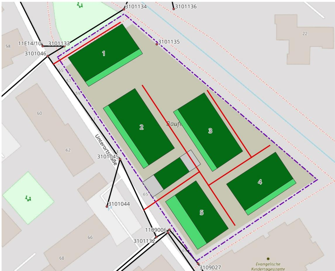
Abbildung 23: Vorschlag zur Verlegung der Schmutzwasserleitungen (rote Linien)
