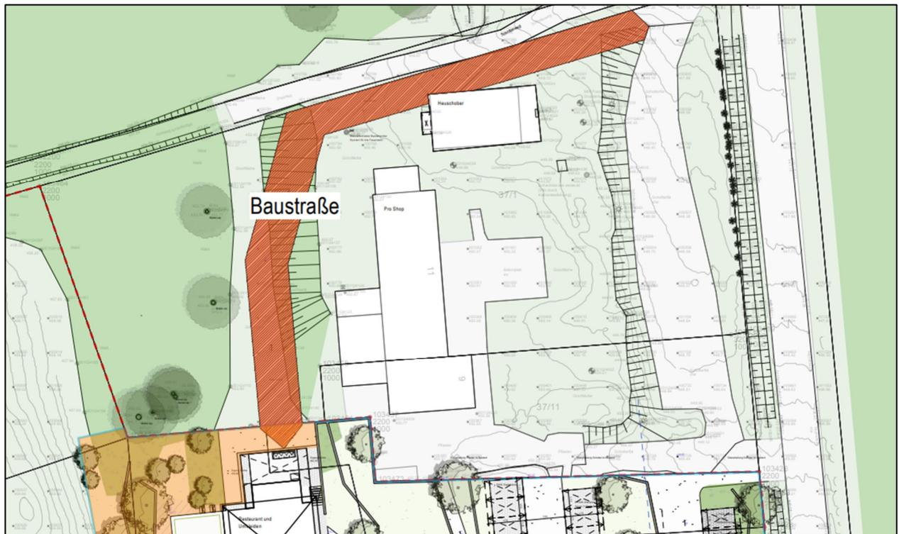
**Abbildung 3** Gestaltungsplan des Bauvorhabens: Nutzungsänderung und bauliche Anpassung eines bestehenden Restaurants. Zum Bauabschnitt Nr. 1 zu errichtende Baustraße. (Quelle: Landschaftsarchitekten PartG mbB Rabsilber, Heckmann, Giese Planstand: 14.03.2025)
