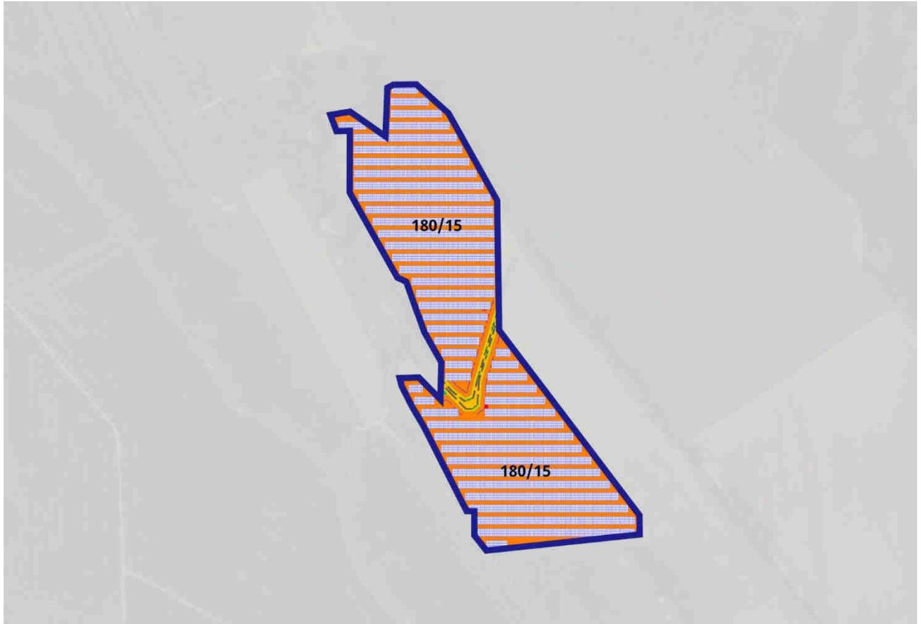
Die Modulreihennormalen sollen mit einer Ausrichtung auf  $180^\circ$  Süd bei einer Aufneigung auf  $15^\circ$  montiert werden.
