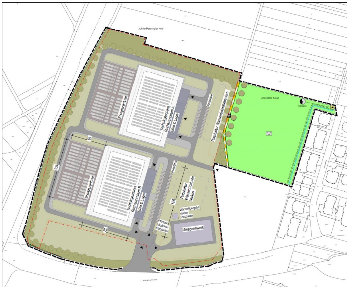
Abbildung 15: Masterplan zur Errichtung eines Rechenzentrums campus im Plangebiet (unverbindlicher Planungsstand: 06.12.2024) Quelle: TTSP HWP Consultants GmbH
