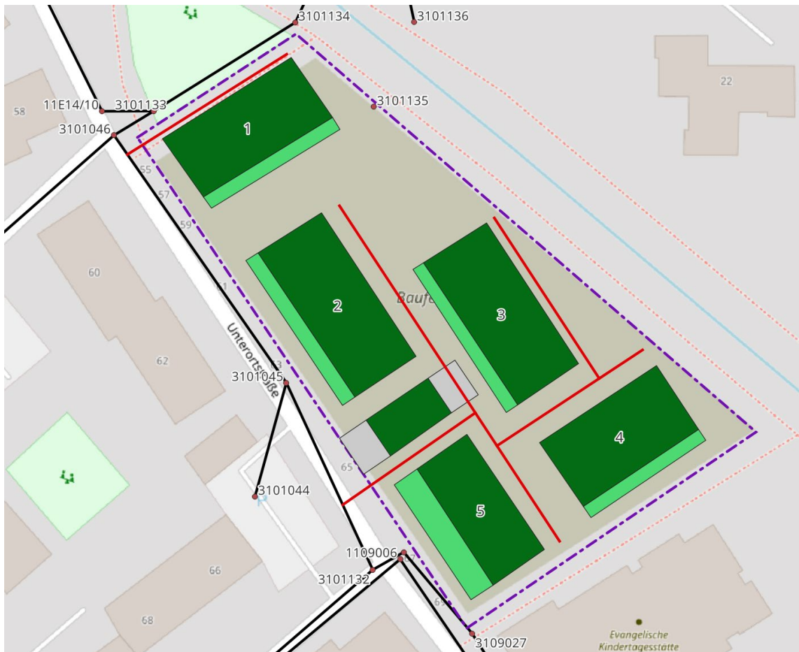
Abbildung 23: Vorschlag zur Verlegung der Schmutzwasserleitungen (rote Linien)
