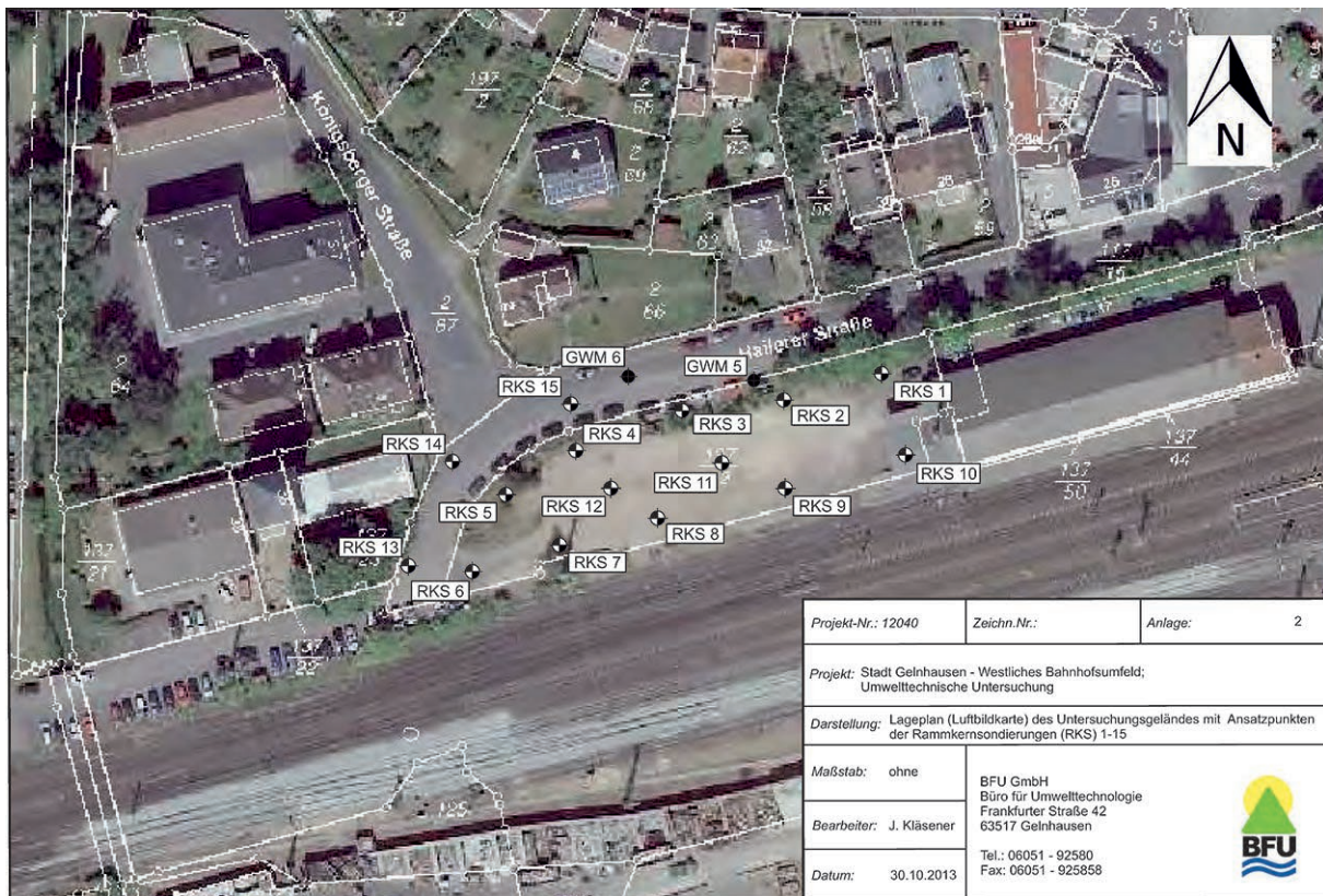
Abb. 12: Lageplan des Untersuchungsgebietes mit Ansatzpunkten der Rammkernsondierungen (RKS) 1-15 (Quelle: BFU GmbH, Gelnhausen, 2013)
